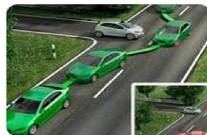
9-rasm. Dinamik turg'unligini ta'minlash (ESP) elektron tizimli avtomobillarni xarakatlanishi.
